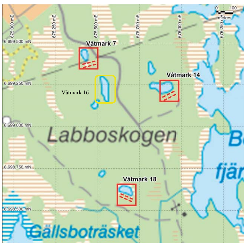
Figur 1-1. Karta med de aktuella våtmarkernas lägen och SKB-nummer. Streckade linjer indikerar lägena för profiler för resistivitets- och IP-mätningar. Våtmark 16, som mättes 2013, visas med gul rektangel.
