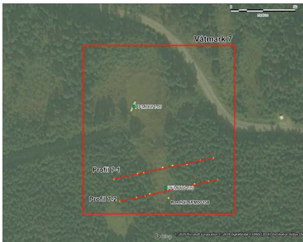
Figur 3-1. Karta över våtmark 7 som visar de två mätprofilernas geografiska lägen (röd streckade linjer) samt positionen på inmätta punkter (gula diamanter) och borrhål (gröna fyrkanter).
