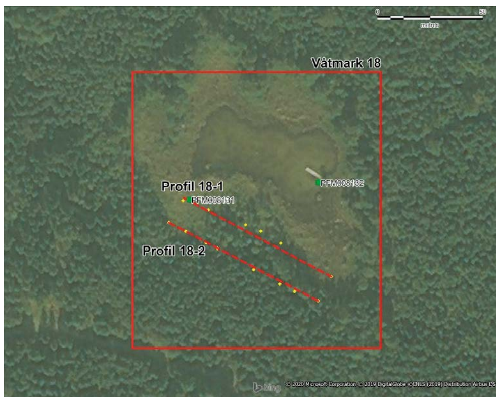
Figur 3-3. Karta över våtmark 18 som visar de två profilernas geografiska läge (röd streckade linjer) samt positionen på inmätta punkter (gula diamanter) och borrhål (gröna fyrkanter).
